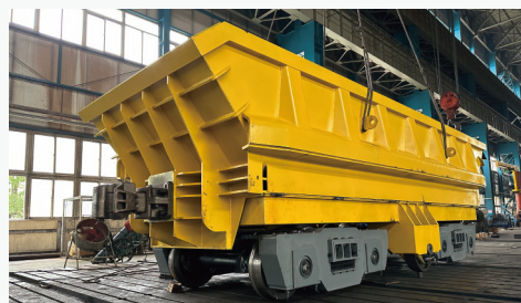
20m 3 大容量低轮压底侧卸式矿车
