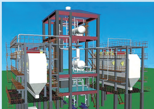
葫芦岛转炉余热锅炉三维设计
